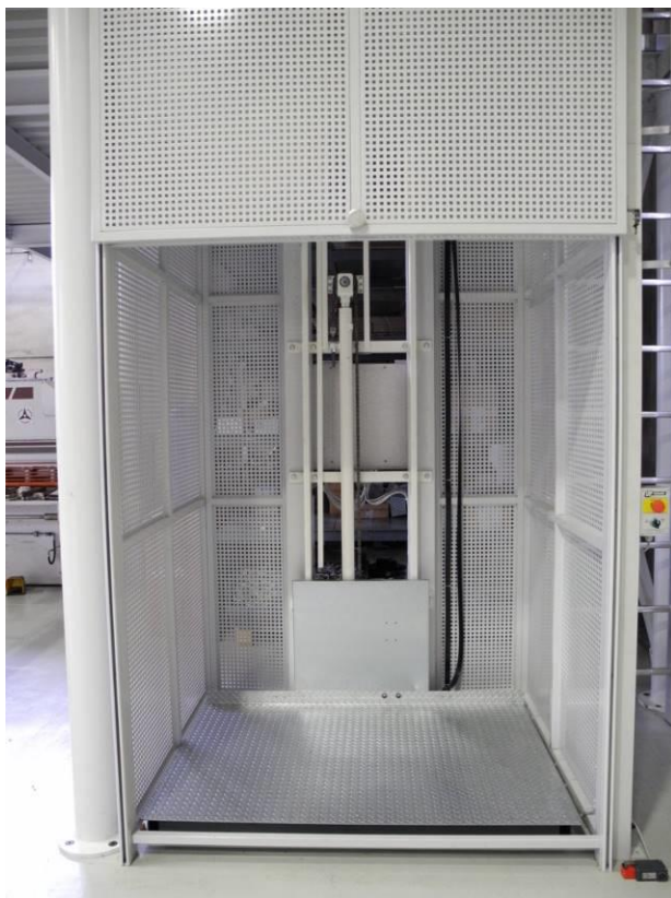
Protezioni inferiore con cancelletto scorrevole verticale ed elettroserratura di sicurezza
