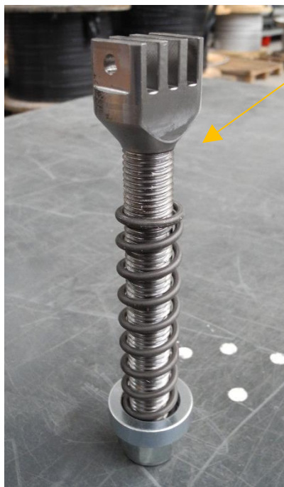
Tirante a vite (per regolazione) Lato Cilindro
